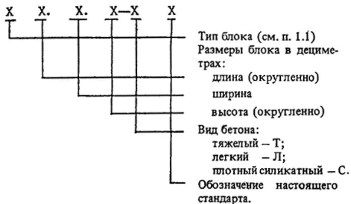
Пример условного обозначения блока типа ФБС, длиной 2380 мм, шириной 400 мм и высотой 580 мм, из тяжелого бетона:
